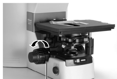
Kroužek nastavení tuhosti otáčení knoflíku makroposunu
