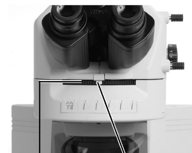
Otočný nosič filtrbloků Číslo filtrbloku, který je v optické dráze
