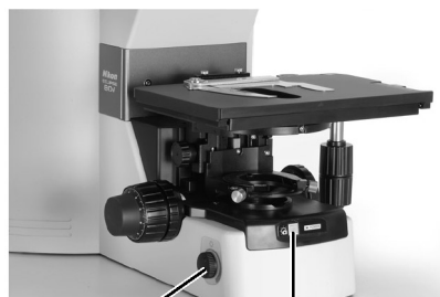
Knoflík nastavení jasu Spínač obnovy nastavení
