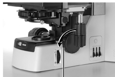
Otočte jemně knoflíkem makroposunu k hornímu dorazu
