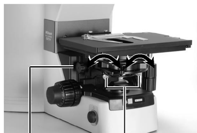
Pomocí knoflíku zaostření kondenzoru zaostřete kondenzor Vycentrujte kondenzor pomocí centrovacích šroubů
