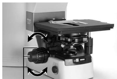
Pomocí knoflíků makroposunu/ mikroposunu zaostřete preparát
